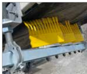
Fingrarnas utformning på segment 2701 ger en lång livslängd och bra rengöring.
