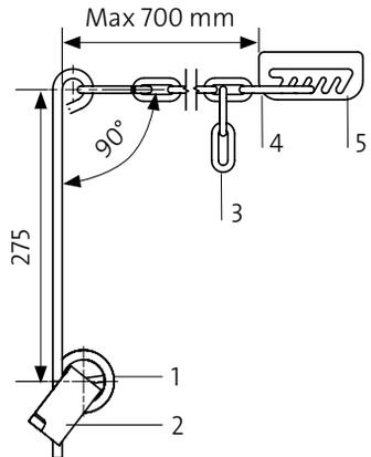
Halterung H und der Federhebelarm werden bei den meisten Vending Abstreifern verwendet. Für größere Bandbreiten verwenden wir den Halter HD und zwei Federhebelarme. Eine detaillierte Montageanleitung wird mit allen Bandabstreifern mitgeliefert.
