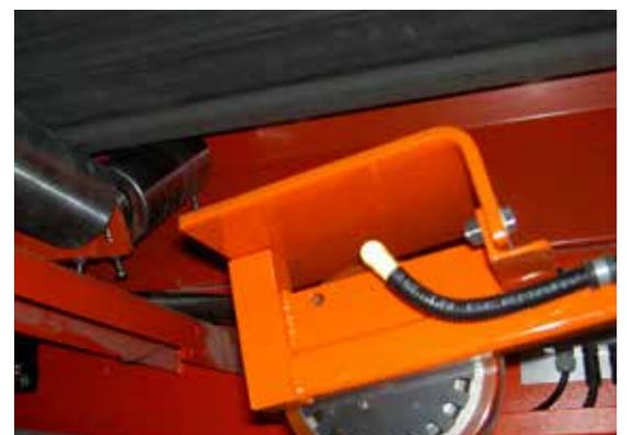
Alle unsere Bandwaagen-Computer OJ1436 sind mit einem eingebauten Drehzahlmesser-Simulator ausgestattet, aber dieser sollte nur bei kürzeren Förderbändern mit konstanter Geschwindigkeit angewendet werden.
